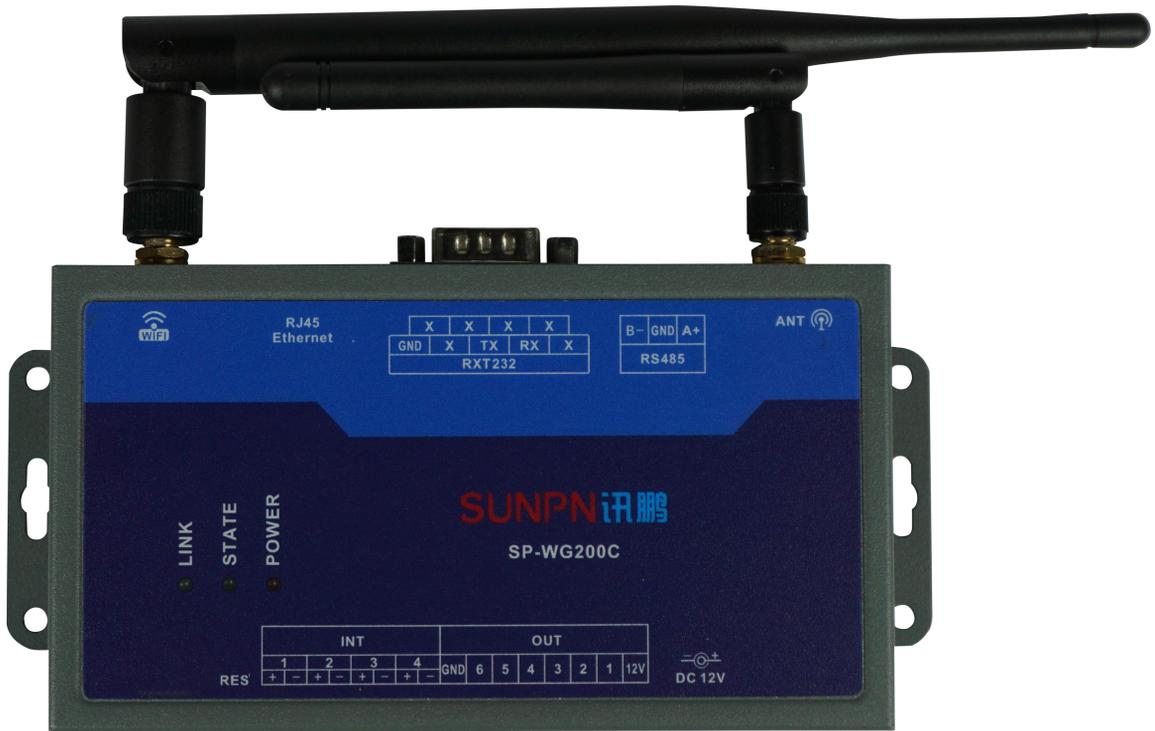
深圳市讯鹏科技有限公司自主研发的SP-WG200C网关，采用业内工业级高性能嵌入式结构，并针对智能制造、智能家居、智慧农场、工业控制、工厂设备等数据的采集传输与控制领域，做了专业的一体化设计，通过该网关用户无需关心具体细节，只需简单设置即可实现以太网 / WIFI / RS232 / RS485 / RF433 / IO等设备之间数据交换，且网关内嵌协议自带输入输出功能，用户通过简单指令并可方便的采集设备的开关信号、计数信号以及输出信号对设备的控制，从而轻松实现物联网。
