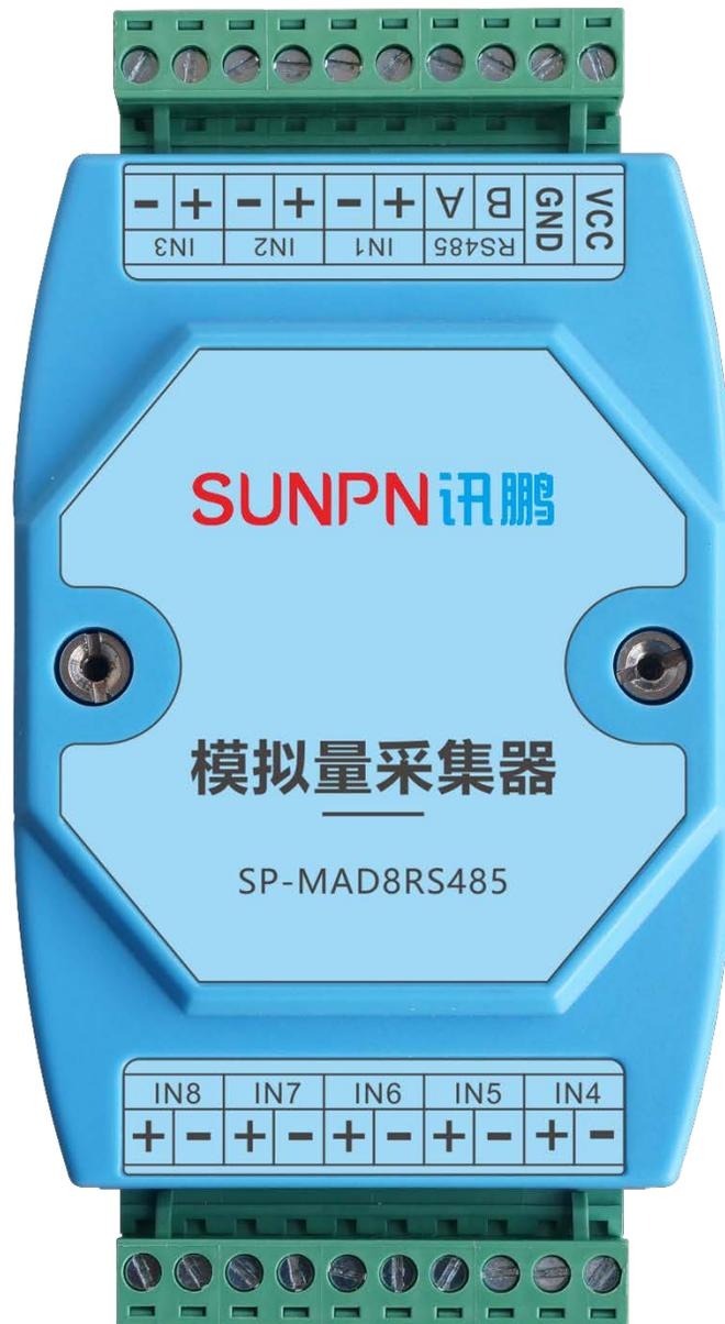
SP-MAD8RS485是一款工业级的模拟量采集产品，8通道差分输入，采用24位高精度ADC芯片、精度高达 $\pm 0.1\%$ 。支持-10V ~ +10V、-5V ~ +5V、-1V ~ +1V、-500mV ~ +500mV、-150mV ~ +150mV、-20mA ~ +20mA、4mA ~ 20mA量程2通道差分输入。RS485通讯接口光电隔离，AD模数接口光电隔离；通讯协议采用标准的MODBUS\_RTU协议，同时支持讯鹏配套协议，工业级标准，适用于各种工业场合及自动化系统集成。
