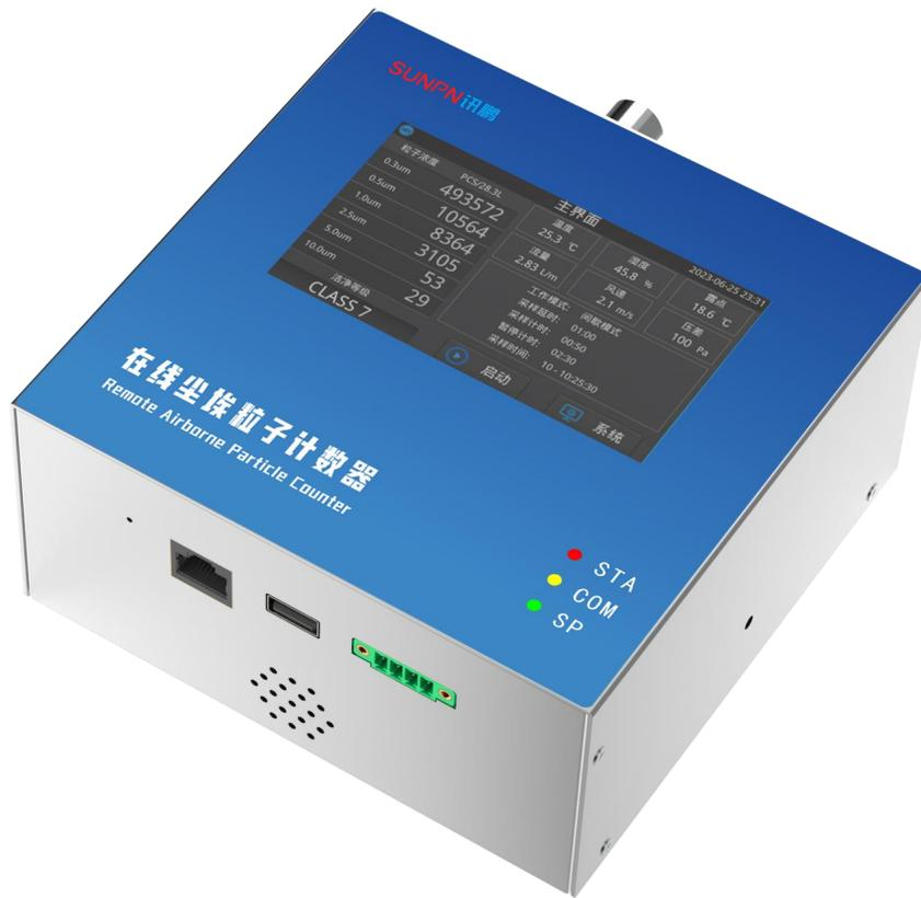
本产品采用工业级粒子计数传感器结合嵌入式设计，整合了温湿度、PID流量控制、工业级触摸彩屏、标配 RS485/RJ45 和选配无线通讯技术，以多种方式精确输出 0.3、0.5、1.0、2.5、5、10um 六个通道的颗粒物数量，支持数据存储、报警及远程升级。
